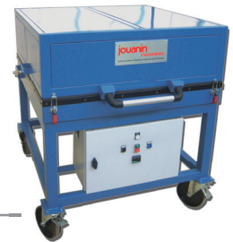
Chauffage de flasques moteur pour train
